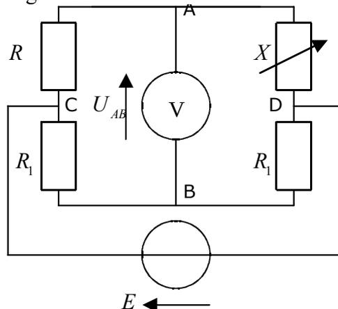
La tension  $U_{AB}$  est mesurée à l'aide d'un voltmètre dont la résistance interne est supposée infinie.
