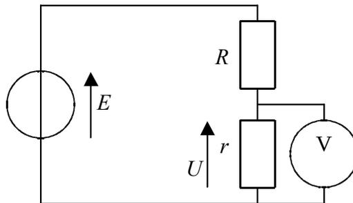
où  $E$  désigne la force électromotrice de la source idéale de tension,  $r$  est une résistance calibrée de valeur fixe  $r=100,0\Omega$ .
