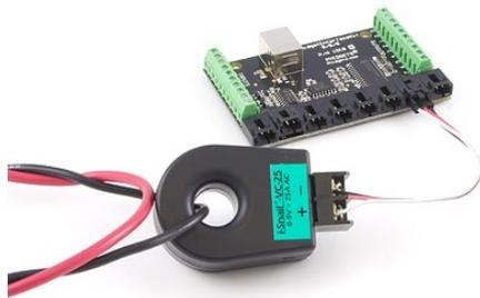
Capteur de courant alternatif auto-alimenté délivrant une tension continue 0 à 5 Vcc proportionnelle à l'intensité passant au travers du trou central.
